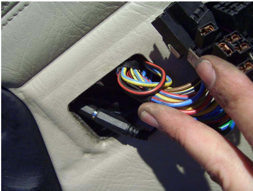
Stecker zur „Fensterheberkabelöffnung“ fummeln und verbinden evtl. mit Isoband sichern, Türgriff anbauen
