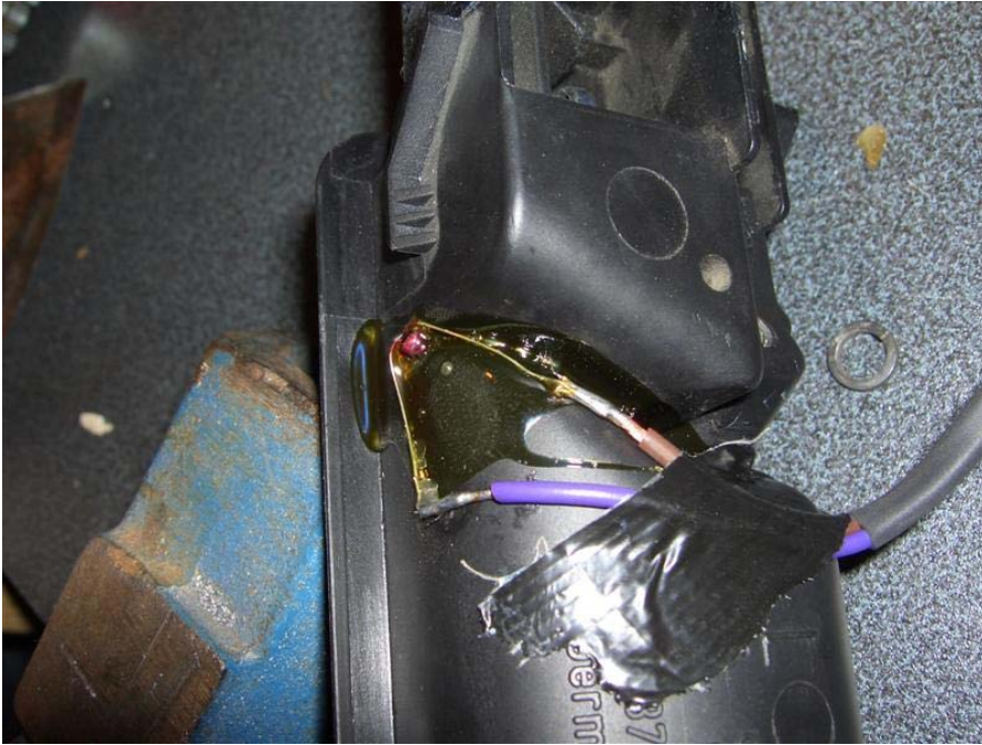
Birne einkleben, trocknen lassen, Kabel anlöten und mit Gaffa oder Isoband fixieren
