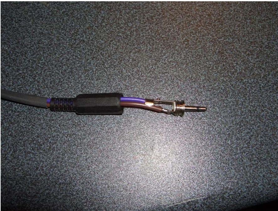
Schrumpfschlauch und Steckerverkleidung!!! aufschieben, dann Stecker (oder Buchse) anlöten, Schlauch schrumpfen
